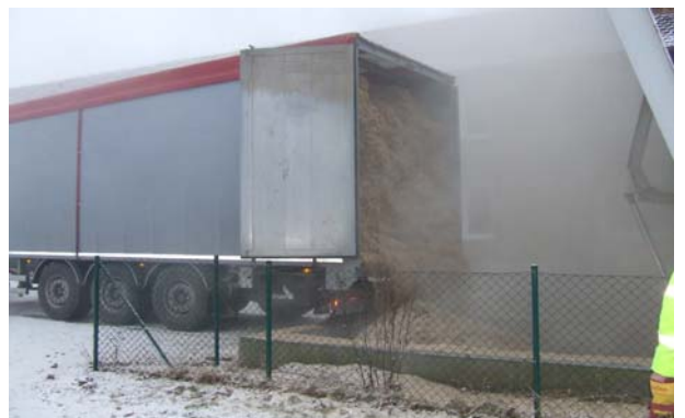
Bild 8: das Entladen beginnt, die Staubentwicklung bestätigt den geringen Wassergehalt des Häckselgutes (hoher Heizwert)
