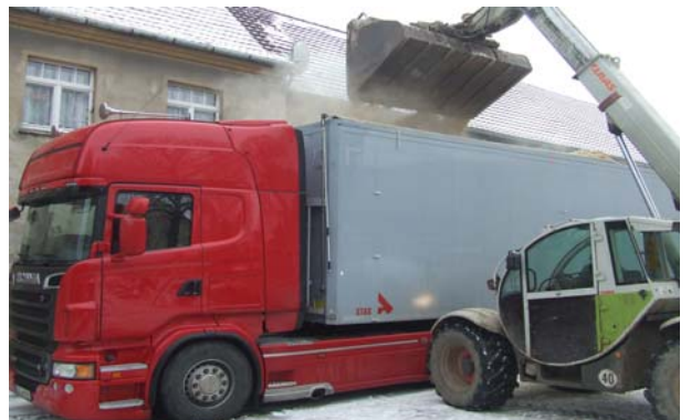
Bild 6: ein Schubbodenfahrzeug (walking-floor) ist fast vollständig beladen (ca.90 m 3 )
